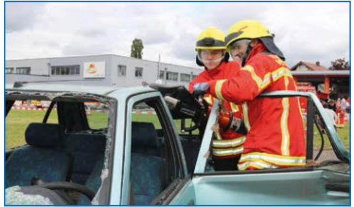
Die hydraulische Schere ist rund 15 kg schwer und knackt ohne Schwierigkeit den Holm eines Autodachs
